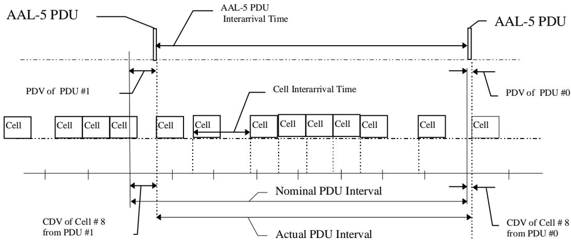
**Figure A-8 AAL-5 PDU Stream to/from ATM**
